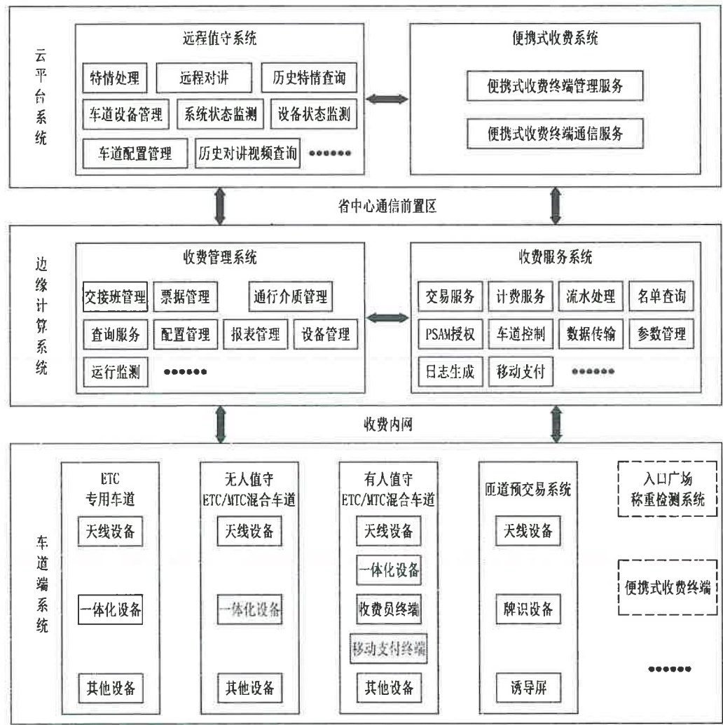
图1 智慧云收费系统总体架构图
